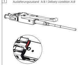
Innengehäuse und LC-Stecker aus dem Außengehäuse herausschieben Push inner housing and LC-connectors to remove outer housing
